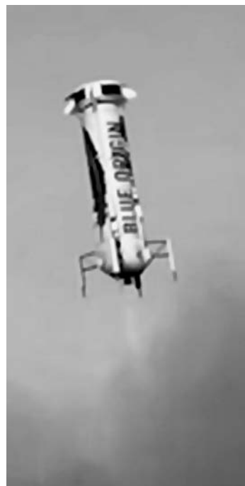
Мягкая посадка многоразовой одноступенчатой ракеты BE-3. Испытательный полигон в штате Техас. 23 ноября 2015 г. Фото компании “Blue Origin”.
