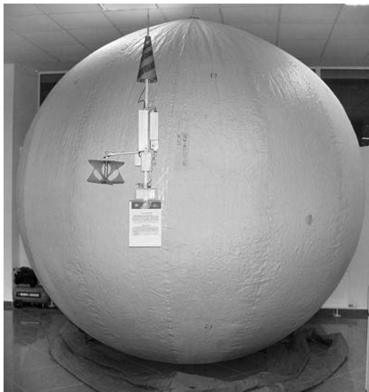
Аэростат для дрейфа в атмосфере Венеры диаметром 3,4 м и гондола с радио-комплексом и приборами. Музей ИКИ РАН. Фото автора.
